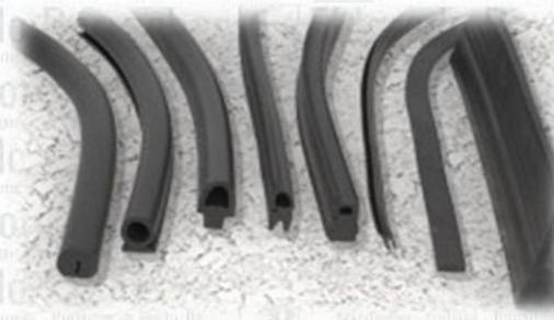
Perfis trafilados para os mais diversos segmentos da indústria como: construção civil, eletroeletrônica, automotiva, furgões, encarroçadoras, madeira, equipamentos, câmaras frigoríficas e casas de comércio especializadas. Processados em borrachas SBR, NBR, EPDM, Policloroprene e outros na faixa de dureza de 50 a 90 Shore A.
